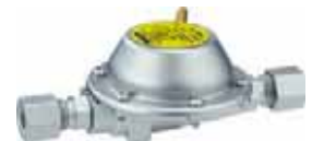
9 VORDRUCKREGLER TYP DE 50/30 S 0,8kg/h, 30mbar, bds. RVS8. Zur sicheren und normgerechten Integration von 30mbar Gasgeräten in 50mbar Flüssiggasanlagen in Fahrzeugen und Booten. 9955457 68,25
