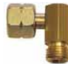
34 WINKEL-ÜBERGANGSSTÜCK Winkel- Übergangsstück links-links; G ¼" LH-ÜM x G ¼" LH-KN. Maße 3,0 x 2,9 x 1,7 cm (B x H x T). 9919056 14,95
