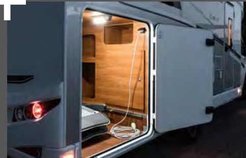
Beleuchtung und 230-V-Steckdose in der Heckgarage.
