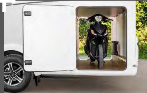
Die Heckgaragen der Einzelbettmodelle sind besonders hoch und beidseitig beladbar durch Stauraumklappen links und rechts.
