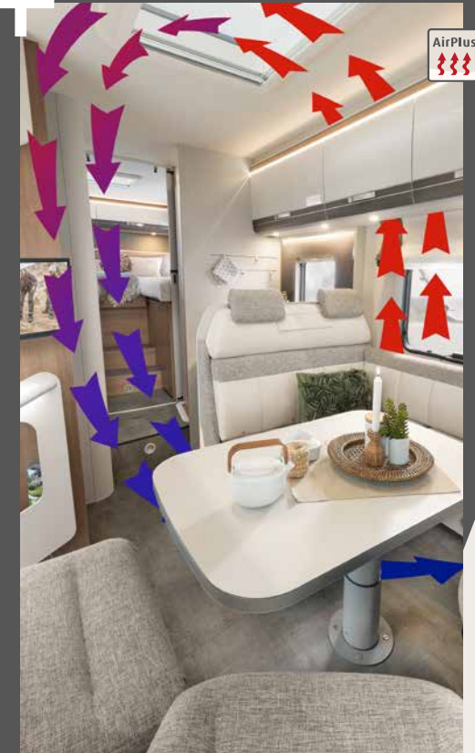
Das AirPlus-System verhindert die Bildung von Kondenswasser hinter den Dachschränken.
