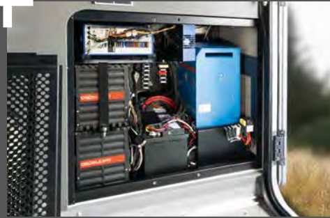
Mehr Autarkie dank neuester Lithium-Ionen-Technik mit 1600 W oder 3000 W Wechselrichter (Option).
